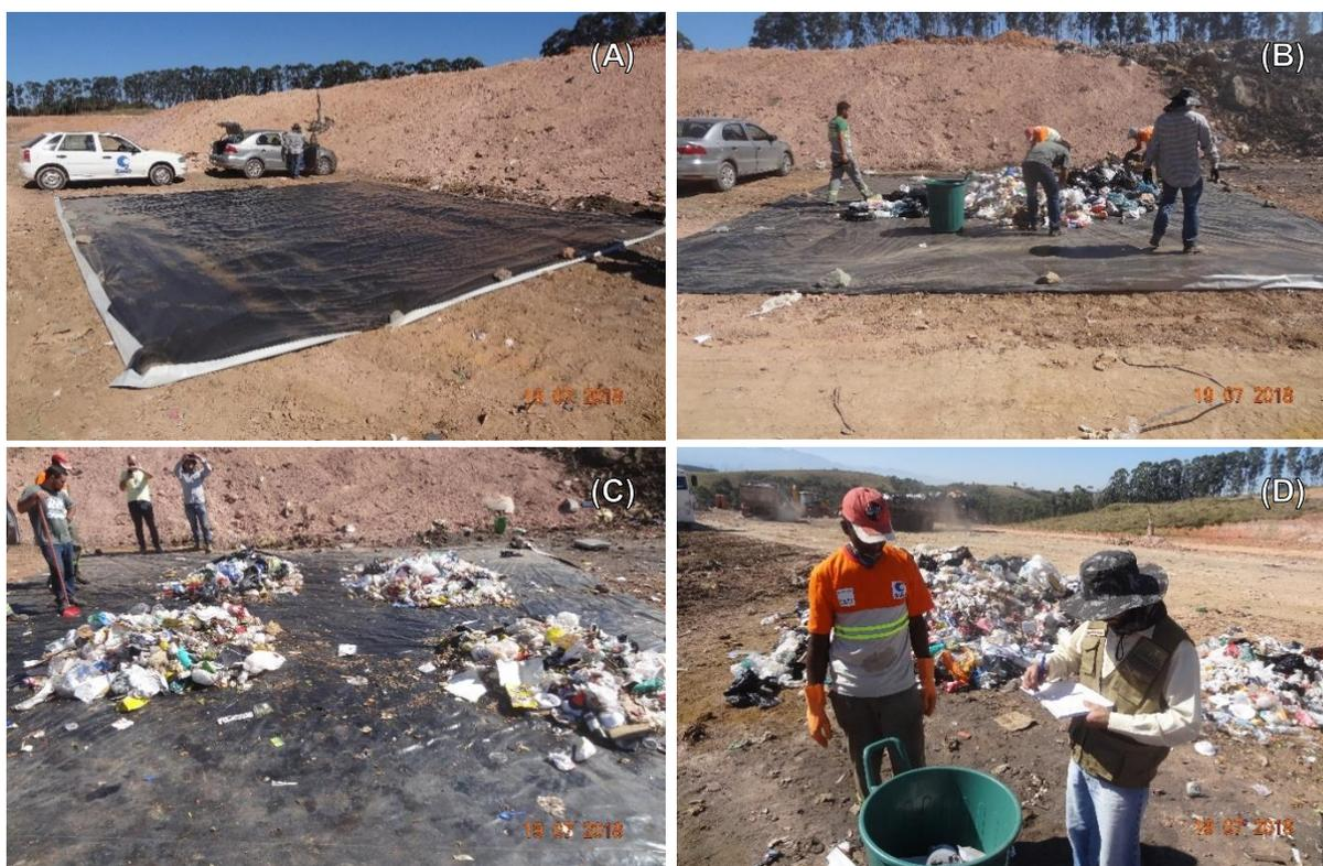
**Figura 3 – Realização do ensaio de determinação da massa específica aparente dos resíduos domiciliares e de prestadores de serviços de Guaratinguetá.**
