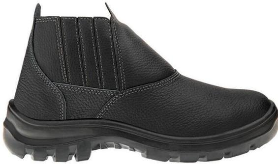
Calçado de segurança em couro curtido ao cromo, preferencialmente com elásticos laterais, acolchoado na região do tornozelo, solado antiderrapante em duas densidades distintas, injetados diretamente no cabedal, bico de conformidade ou bico em material plástico.
